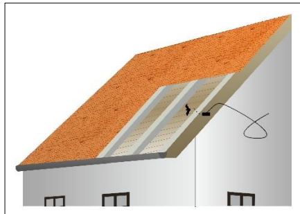
Bardage de toiture accessible aux chiroptères (Sources : Photo 1 : Thomas Frank, schémas 1 et 2 : Cerema Est)
