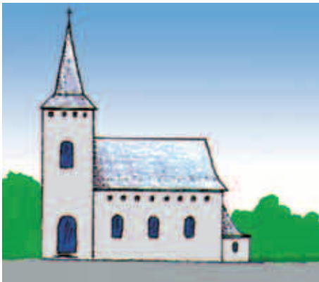
Emplacement des trous de boulin
