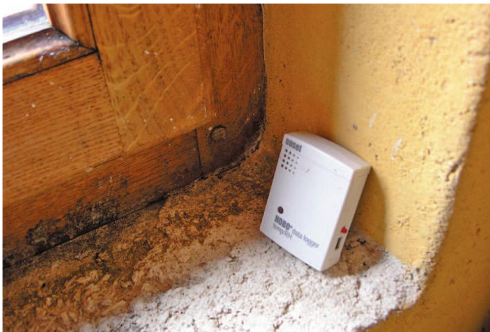
L'enregistreur automatique de température et hygrométrie est un moyen efficace de caractériser les conditions microclimatiques d'un lieu. © Frédéric Malgouyrès/ONF.
